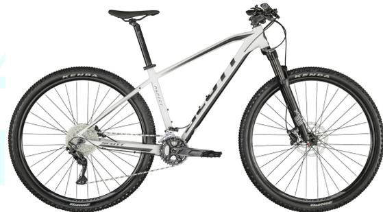
Le Scott Aspect 930 est un VTT semi-rigide conçu pour être léger, efficace et à un prix raisonnable. Doté d'un système de blocage de la fourche au guidon, de freins à disque Shimano et de composants Syncros, ce modèle est parfait pour les débutants et pour les vététistes soucieux de leur budget.
